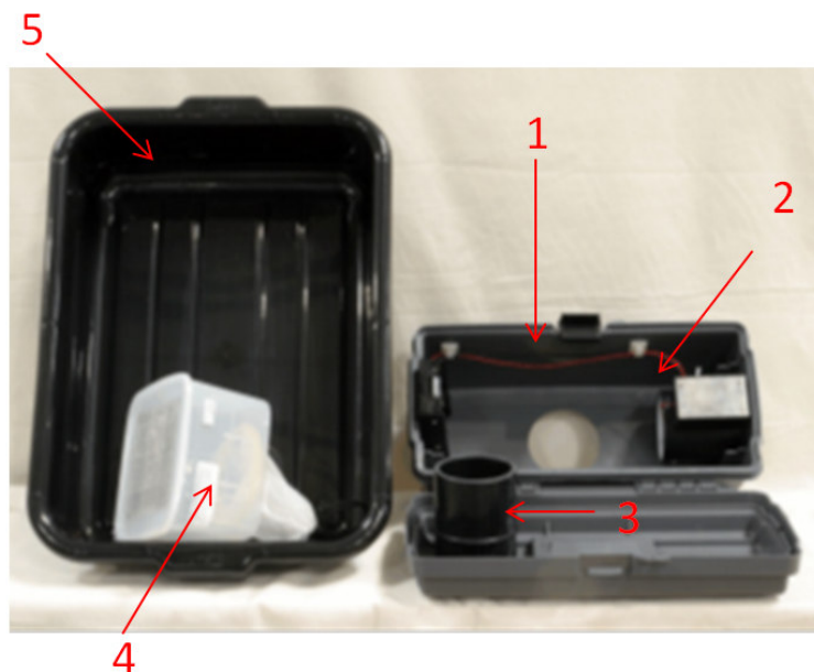
Figura 2: trappola tipo Gravid non assemblata.
