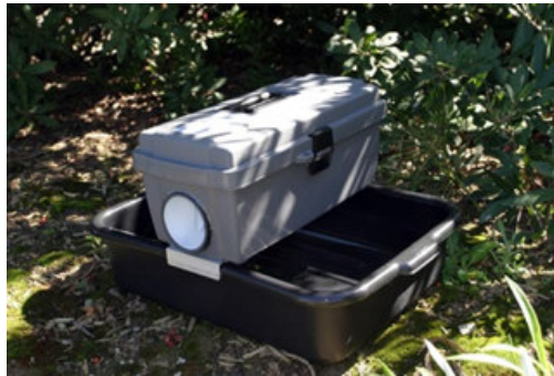
Figura 5: trappola Gravid assemblata e posizionata.
