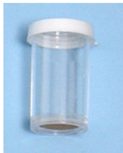
Figura 9: barattolo per la raccolta delle zanzare catturate con aspiratore elettrico.
